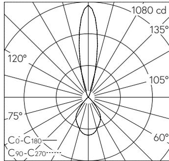
LED 3000 K 9 W 676 lm-h / CIE Flux 89 99 100 73 100 / B84 selon DIN 5040
