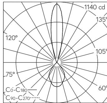
LED 4000 K 9 W 718 lm-h / CIE Flux 89 99 100 73 100 / B84 selon DIN 5040
