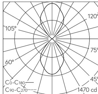
LED 4000 K 19 W 2196 lm-h / CIE Flux 88 99 100 50 100 / C84 selon DIN 5040
