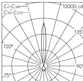
LED 4000 K 19 W 1615 lm-h / CIE Flux 88 99 100 68 100 / B84 selon DIN 5040
