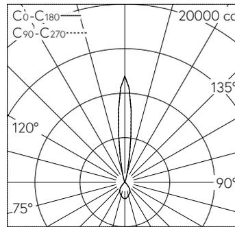
LED 3000 K 39 W 3064 lm-h / CIE Flux 86 99 100 69 100 / B84 selon DIN 5040
