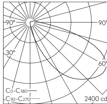
LED 4000 K 25 W 3055 lm-h / CIE Flux 19 55 86 95 100 / A11 selon DIN 5040
