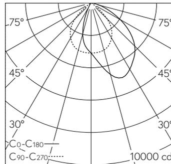
LED 4000 K 56 W 6127 lm-h / CIE Flux 63 92 99 100 100 / A60 selon DIN 5040
