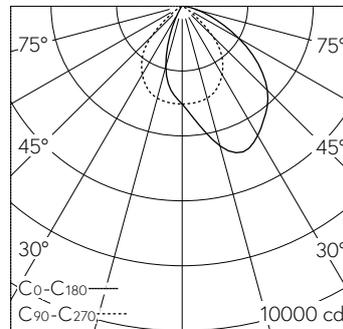
LED 3000 K 56 W 5974 lm-h / CIE Flux 63 92 99 100 100 / A60 selon DIN 5040
