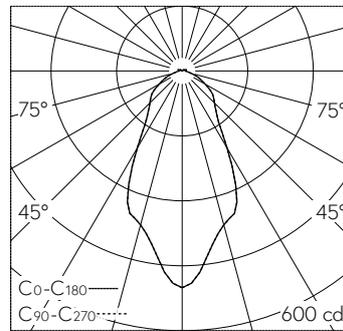
LED 3000 K 10.6 W 631 lm-h / CIE Flux 64 87 97 96 100 / A51 selon DIN 5040
