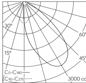
LED 3000 K 20.2 W 1896 lm-h / CIE Flux 69 95 99 100 100 / A60 selon DIN 5040
