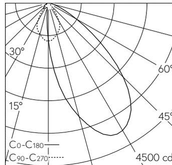
LED 3000 K 35.6 W 2879 lm-h / CIE Flux 68 94 99 100 100 / A60 selon DIN 5040
