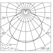
LED 3000 K 8.8 W 906 lm-h / CIE Flux 40 70 89 79 100 / B32 selon DIN 5040
