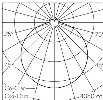
LED 4000 K 25.6 W 3293 lm-h / CIE Flux 43 74 92 88 100 / B31 selon DIN 5040
