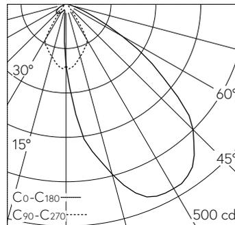
LED 3000 K 4.4 W 350 lm-h / CIE Flux 68 95 100 100 100 / A60 selon DIN 5040
