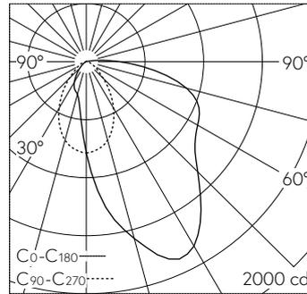
LED 3000 K 18.8 W 2298 lm-h / CIE Flux 43 71 91 99 100 / A30 selon DIN 5040
