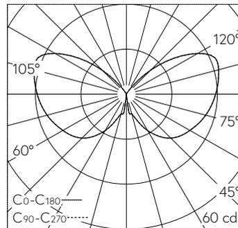
LED 3000 K 5 W 356 lm-h / CIE Flux 14 39 67 52 100 / C11 selon DIN 5040
