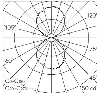
LED 3000 K 14 W 435 lm-h / CIE Flux 52 84 98 50 100 / C43 selon DIN 5040
