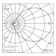
LED 3000 K 16.3 W 1309 lm-h / CIE Flux 19 43 70 57 100 / C11 selon DIN 5040
