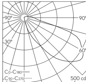
LED 3000 K 9 W 703 lm-h / CIE Flux 17 55 87 91 100 / A11 selon DIN 5040
