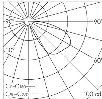
LED 3000 K 6.8 W 48 lm-h / CIE Flux 16 51 83 99 100 / A10 selon DIN 5040
