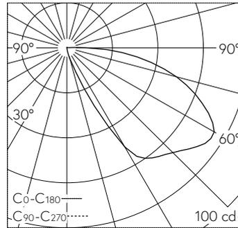
LED 3000 K 8.8 W 111 lm-h / CIE Flux 16 51 83 99 100 / A10 selon DIN 5040
