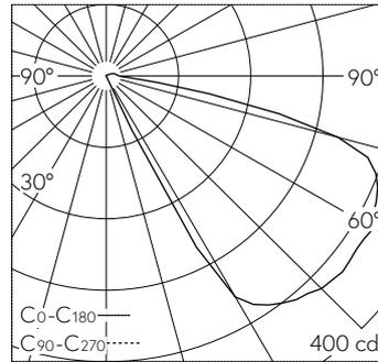
LED 4000 K 7 W 433 lm-h / CIE Flux 14 51 86 98 100 / A10 selon DIN 5040
