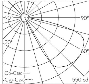
LED 4000 K 9 W 571 lm-h / CIE Flux 14 51 86 98 100 / A10 selon DIN 5040
