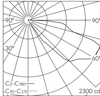
LED 4000 K 22.6 W 2240 lm-h / CIE Flux 4 36 77 98 100 / A10 selon DIN 5040
