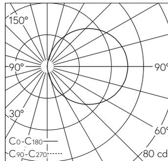
LED 4000 K 3.9 W 143 lm-h / CIE Flux 13 37 66 50 100 / C11 selon DIN 5040
