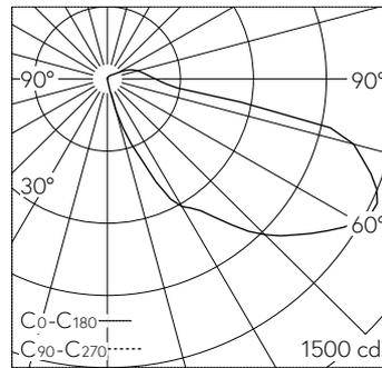
LED 3000 K 22.6 W 2254 lm-h / CIE Flux 15 47 82 89 100 / B11 selon DIN 5040
