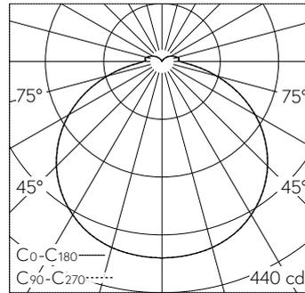
LED 4000 K 16 W 1563 lm-h 124°/124° / CIE Flux 41 72 91 91 100 / A31 selon DIN 5040
