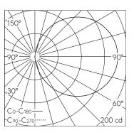
LED 3000 K 6.8 W 601 lm-h / CIE Flux 13 37 66 50 100 / C11 selon DIN 5040
