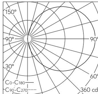
LED 3000 K 10.9 W 1070 lm-h / CIE Flux 13 37 66 50 100 / C11 selon DIN 5040
