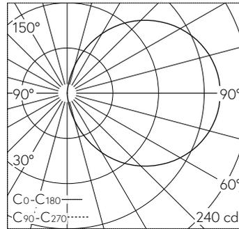
LED 4000 K 6.8 W 566 lm-h / CIE Flux 13 37 66 50 100 / C11 selon DIN 5040
