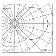
LED 3000 K 8.8 W 883 lm-h / CIE Flux 13 37 66 50 100 / C11 selon DIN 5040
