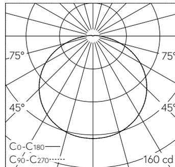
LED 3000 K 5.5 W 479 lm-h 124°/124° / CIE Flux 42 73 92 98 100 / A30 selon DIN 5...
