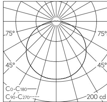
LED 4000 K 5.5 W 491 lm-h 124°/124° / CIE Flux 42 73 92 98 100 / A30 selon DIN 5...
