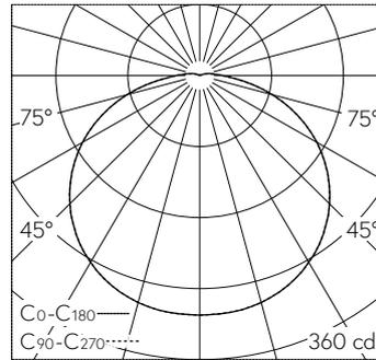
LED 3000 K 13 W 1011 lm-h 128°/128° / CIE Flux 42 73 92 97 100 / A30 selon DIN 5...
