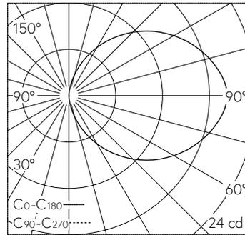
LED 3000 K 2 W 56 lm-h / CIE Flux 11 34 64 50 100 / C11 selon DIN 5040
