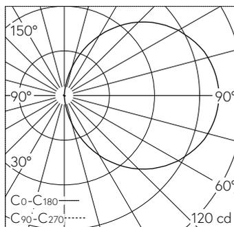
LED 3000 K 10.5 W 211 lm-h / CIE Flux 13 38 67 50 100 / C11 selon DIN 5040
