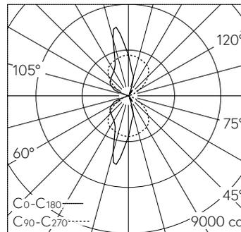
LED 3000 K 73 W 9606 lm-h / CIE Flux 59 89 100 50 100 / C54 selon DIN 5040
