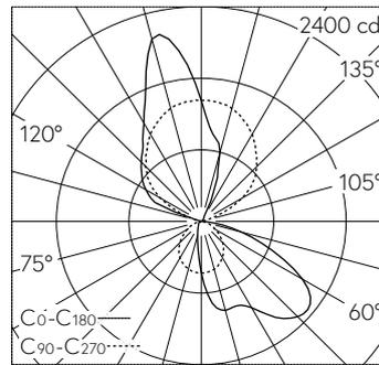
LED 3000 K 38 W 4967 lm-h / CIE Flux 39 75 95 45 100 / C34 selon DIN 5040
