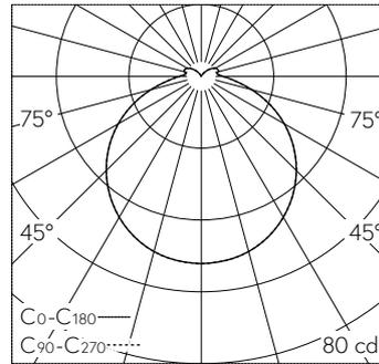
LED 3000 K 3.9 W 272 lm-h 122° / CIE Flux 42 73 91 89 100 / B31 selon DIN 5040
