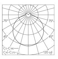
LED 3000 K 5.8 W 440 lm-h 120° / CIE Flux 43 74 92 89 100 / B31 selon DIN 5040
