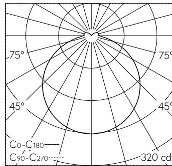
LED 3000 K 11.7 W 731 lm-h 118° / CIE Flux 44 75 93 91 100 / A41 selon DIN 5040
