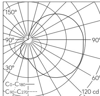
LED 3000 K 5.8 W 532 lm-h / CIE Flux 25 51 76 63 100 / B11 selon DIN 5040
