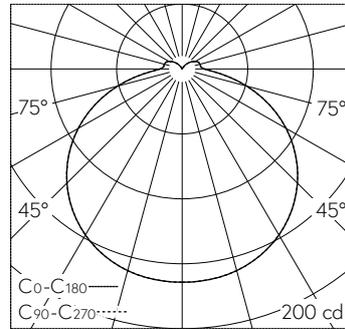
LED 4000 K 5.8 W 627 lm-h 128° / CIE Flux 41 72 91 90 100 / A31 selon DIN 5040
