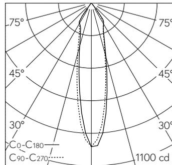
LED 3000 K 5.3 W 307 lm-h / CIE Flux 99 100 100 100 100 / A80 selon DIN 5040
