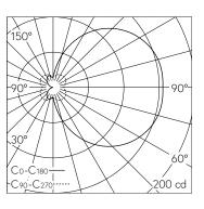
LED 4000 K 6.7 W 666 lm-h / CIE Flux 18 44 71 50 100 / C12 selon DIN 5040
