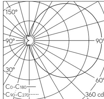
LED 4000 K 11 W 1193 lm-h / CIE Flux 17 42 70 50 100 / C11 selon DIN 5040
