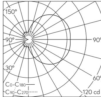
LED 3000 K 4.9 W 364 lm-h / CIE Flux 21 48 74 50 100 / C12 selon DIN 5040
