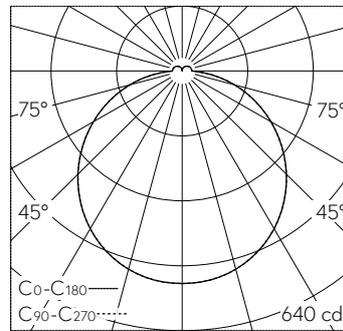
LED 4000 K 15.6 W 1734 lm-h 116° / CIE Flux 44 75 93 93 100 / A41 selon DIN 5040
