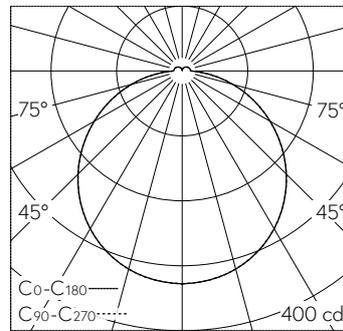
LED 3000 K 15.6 W 1708 lm-h 116° / CIE Flux 45 75 93 94 100 / A41 selon DIN 5040
