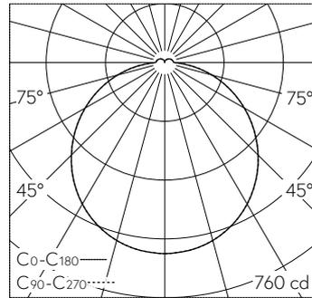
LED 4000 K 22 W 2233 lm-h 116° / CIE Flux 44 75 92 94 100 / A41 selon DIN 5040
